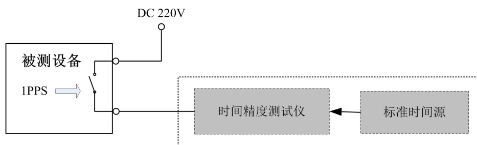
图 3 静态空接点测试示意图
