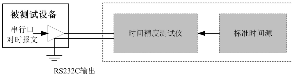
图 10 串行口时间报文测试示意图
